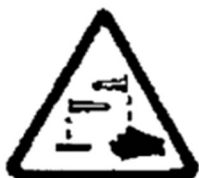
RIESGO DE CORROSION
