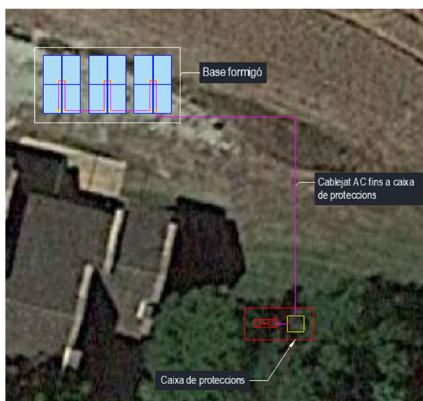
IL·LUSTRACIÓ 15: INSTAL·LACIÓ FOTOVOLTAICA. FONT: GOOGLE MAPS I ELABORACIÓ PRÒPIA.
