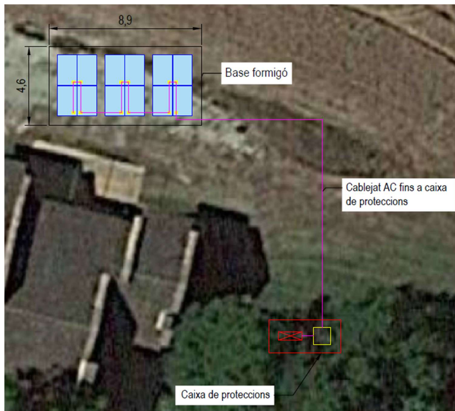
Il·lustració 2. Disposició de plaques i pla de strings
