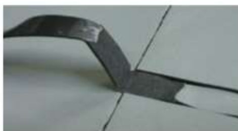
Tirar de cualquier lado de la soldadura
