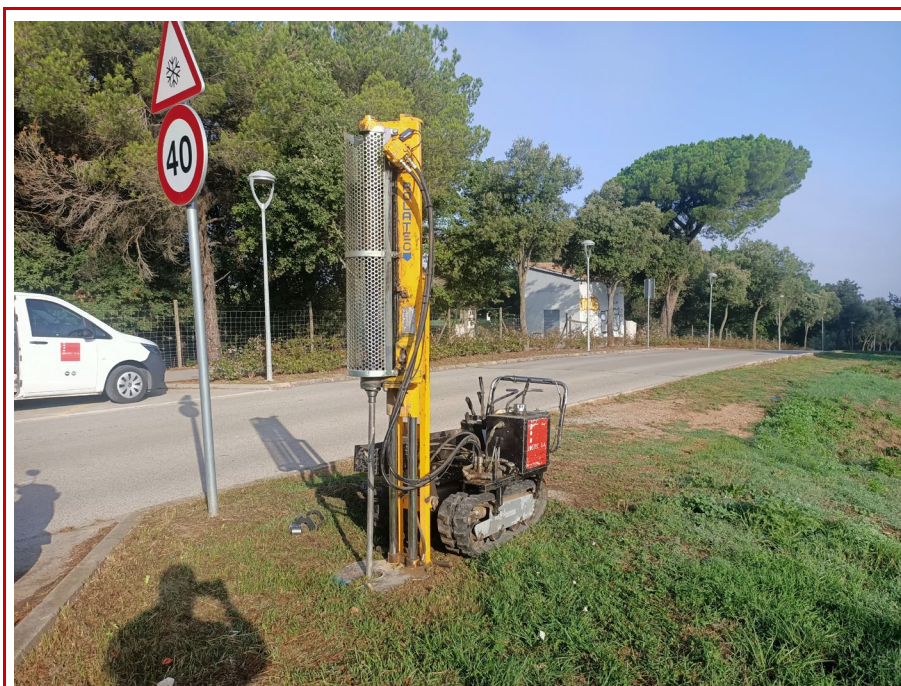
Fotografia 1 – Equip d'assaig penetromètric en el punt d'assaig P-1
