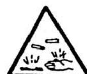
RISC DE CORROSIÓ
